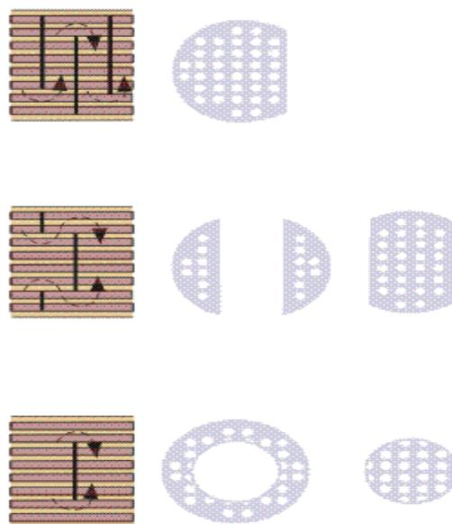
Figure 12 Baffles Arrangement
